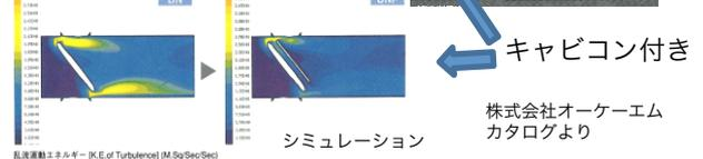
乱流運動エネルギー [K.E. of Turbulence] (M.Sq/Sec)
