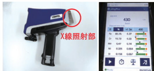
図2 可搬型蛍光X線分析装置(左)とモニター(右)
