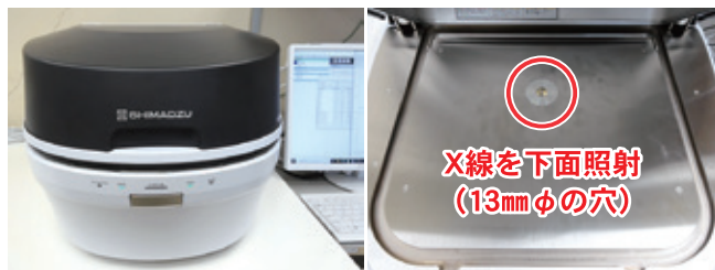
図1 卓上型蛍光X線分析装置(左)と試料室内部(右)
