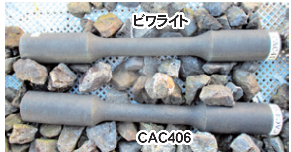
図1 屋外暴露試験10年目の試料の外観
