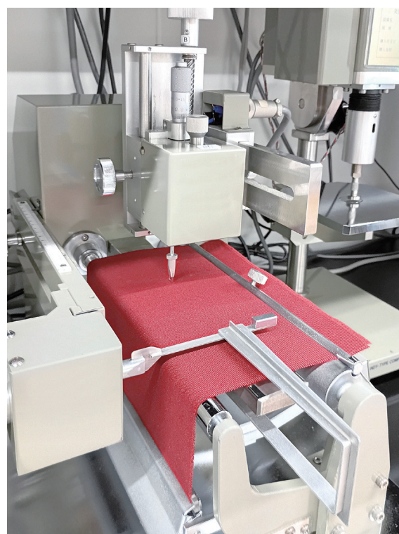
図3 風合い試験機(摩擦係数)
