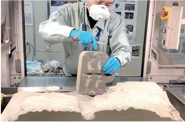
図3 砂型3Dプリンタから砂型を取り出す様子
