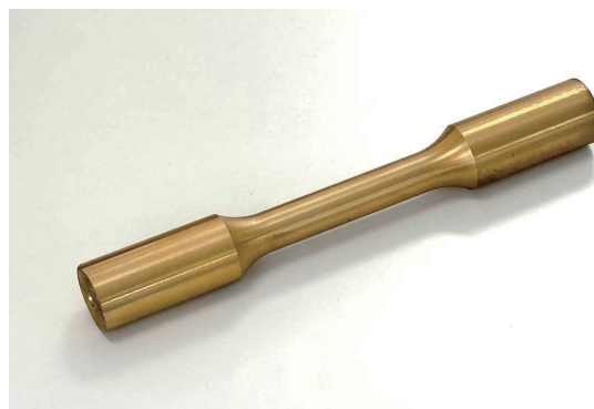
図1 強度試験(引張)に用いる銅合金
