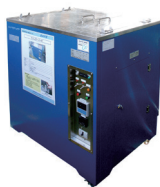
ラウンダーメータ外観 紫外線フェードメータ試験槽 図2 染色堅ろう度試験に使用する機器
