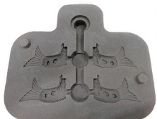
図3 砂型3Dプリンタから砂型を取り出す様子
