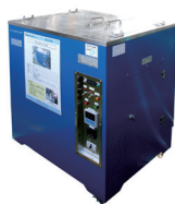
ラウンラメータ外観 紫外線フェードメータ試験槽 図2 染色堅ろう度試験に使用する機器
