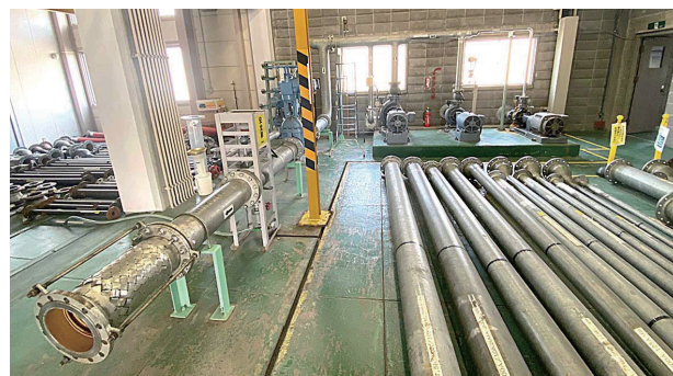
図4 彦根庁舎にある従来のバルブ性能試験装置
