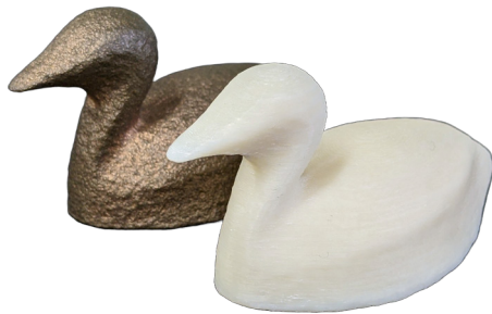
図4 (左) ビワライト製の製品(鋳造品) (右) 3D-プリンタ製の造形物
