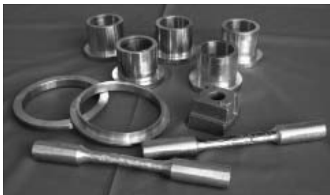
▲ピワライトで铸造した部品及び試験片
