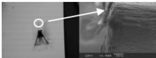
図4 Fe-W合金めっき180°密着曲げ試験
