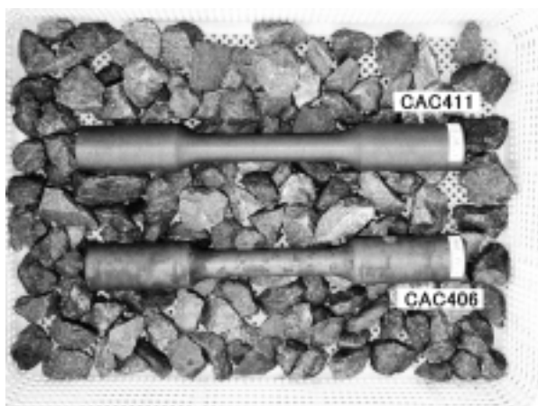
写真6. 屋外暴露1年半後の試料（平成23年12月）
