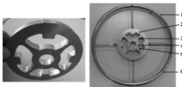
(a) 操作トルク検出ユニット (b) 検出機構付ハンドリム 1: リム 2: 中間リング 3: 小アーム 4: ボス 5: 検知部 6: 負荷用穴
