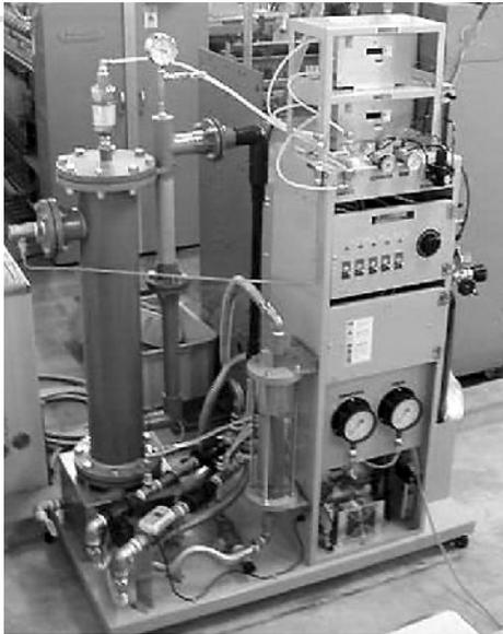
このシステムは、オゾン発生器、オゾン溶解、オゾン滞留、オゾン濃度測定ユニットから構成され、各種廃水のオゾン処理が出来ます。
