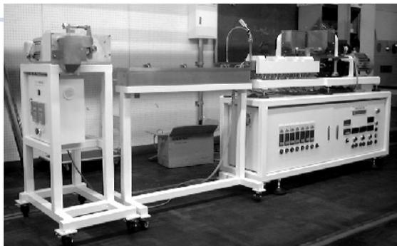
2軸のスクリューで複数材料の混練りを行い、複合ペレットを作成する装置です。定量フィーダー2機を装備しており、材料の特性に合わせたペレットを作成することができます。
