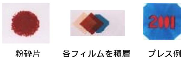
図 3 粉砕片を使用した積層フィルム
