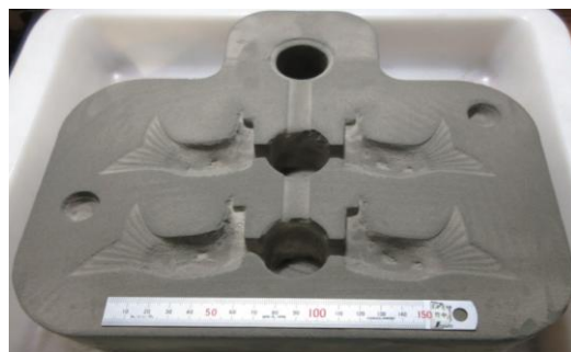
図 4 砂型 3D プリンタから取り出した下型
