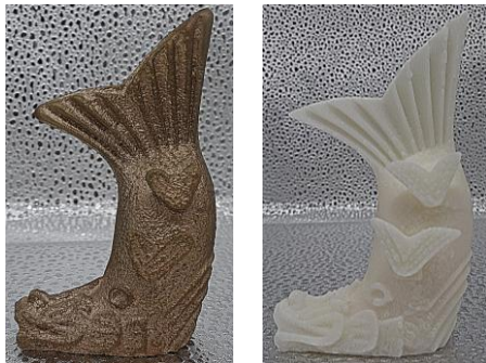
図 6 1/15 レプリカの比較（左：鑄造 右：樹脂）
