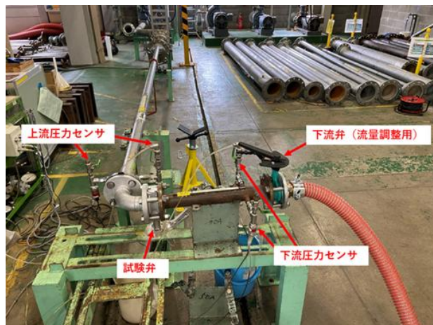
図4 配管構成写真
