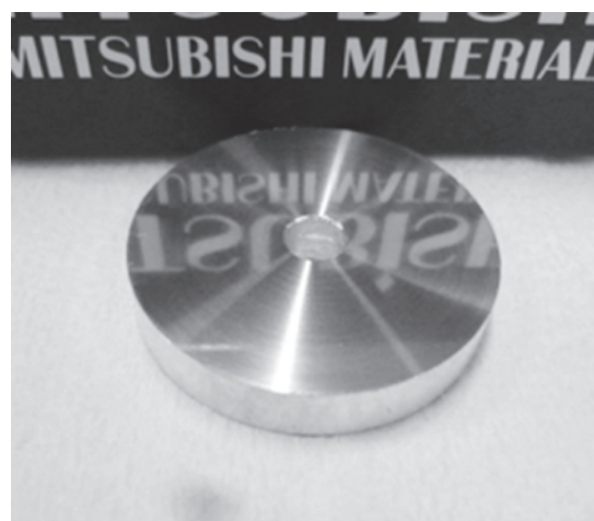
図 3 焼結ダイヤモンドチップで切削したアルミニウム合金基板
