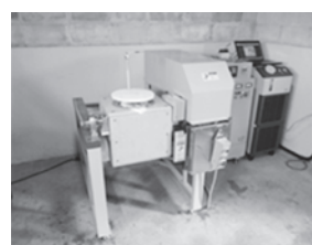
図1 鋳造用電気炉
