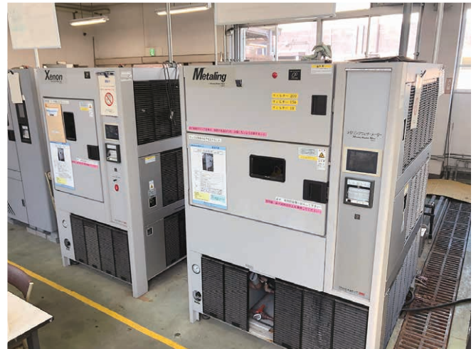
図 当センターに設置しているウェザーメーター
