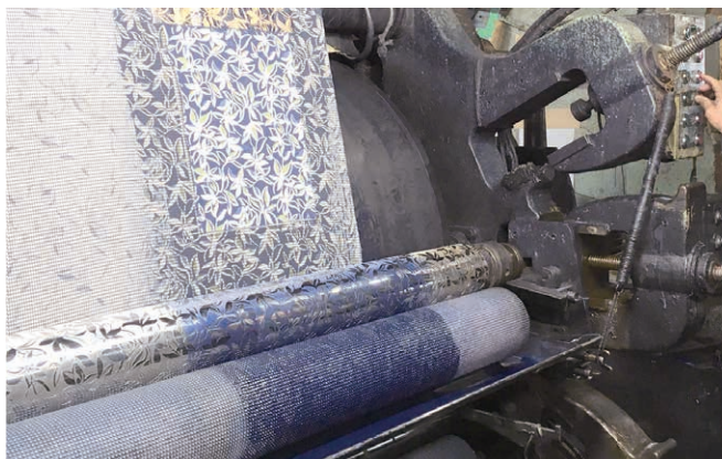
図1 ロール状の金型と捺染機（テストプリント）
