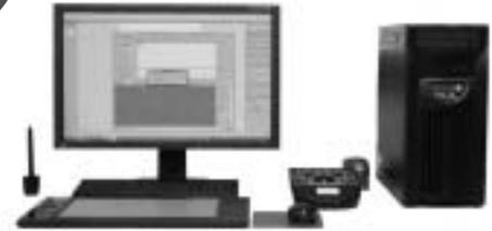
テキスタイルデザインシステムは主にファッション関連のモノづくりを支援するシステムです。織物作製、糸の入力・作製、ニット作製、プリント柄作製、パターン作製、刺繍、マッピングなどについて、それぞれに用意されているメニューどおりに作業するだけで簡単にシミュレーションできます。
