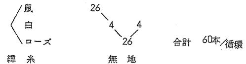
(9)の併染糸の代わりに上記の淡彩に染めた鼠、ローズを配列し、その上に捺染を施し(8)と同様の製織をしたものである。
