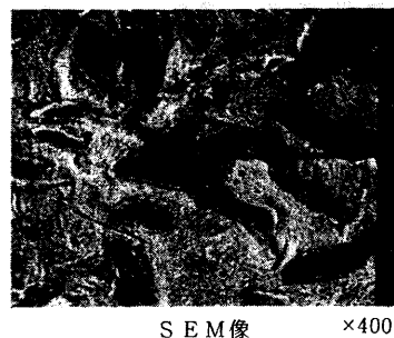
写真8 硫酸・硫酸銅腐食試験後におけるねずみ鋼鉄の組成像（表面）（無処理）
