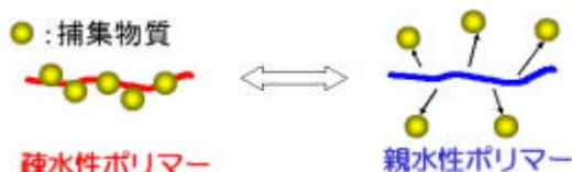
図1 刺激応答性ポリマーによる捕集物質の脱吸着モデル
