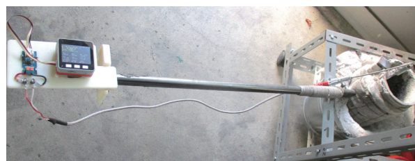
図7 試作した取鍋センサ
