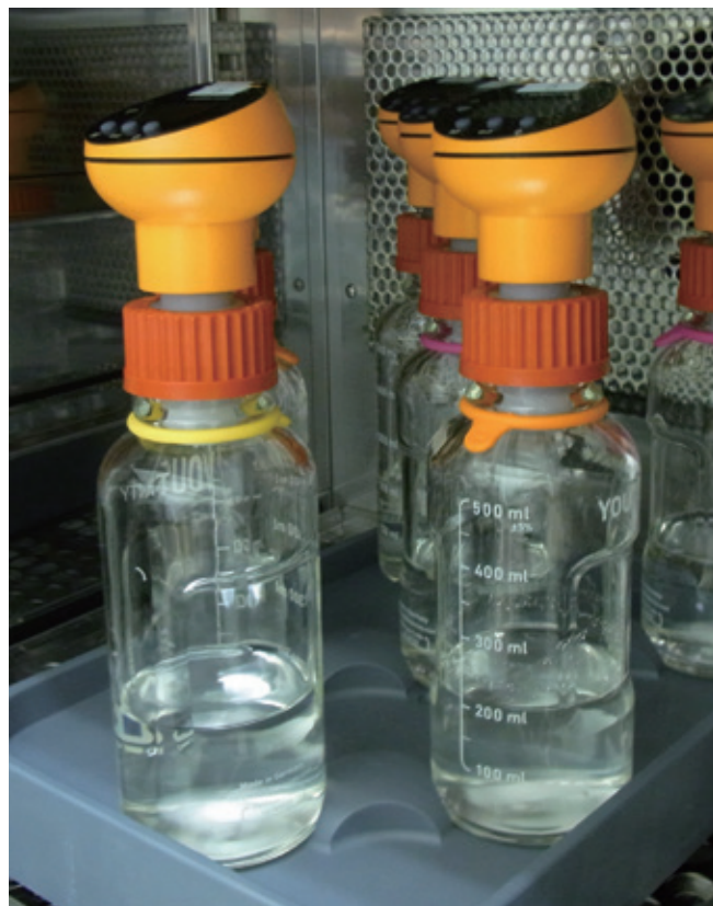
図1 生分解性評価装置による水中生分解性試験
