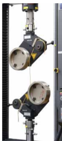
図2 ケーブルチャック(直径150mm)での引張試験
