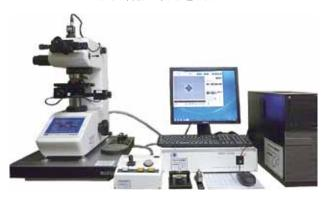
ビッカース硬さとヌープ硬さは同一の試験機を用いて、そ れぞれの圧子を変更して測定を行います。ヌープ圧子は薄 膜など薄い材料に使用します。
