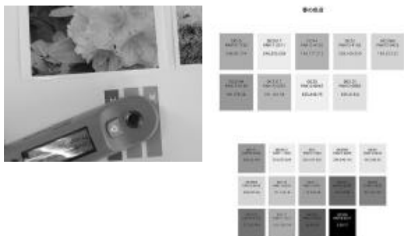
図 3：測色 (DIC color guide を簡易型測色計で測色)
