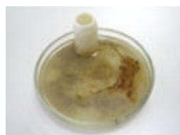
写真5 反応後のFRP廃棄物試料
