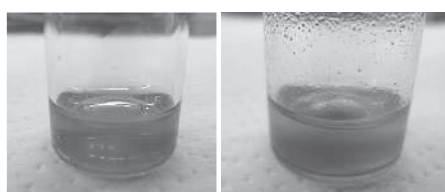
完全溶解 不溶 図2 カテキンの可塑剤溶解性 (可塑剤 / カテキン=100 / 1)
