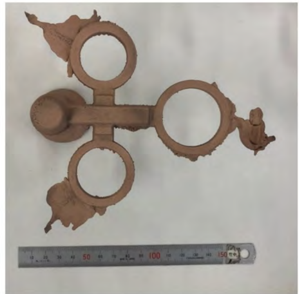
図 12 図 11 の木型で作製した砂型に castingした casting物
