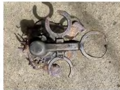
図 6 湯流れ不良の様子
