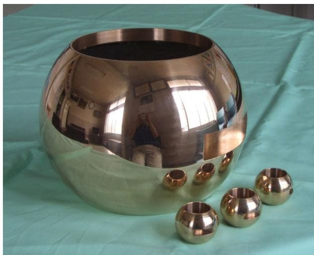
写真1 ビワライトで鋳造した玉型弁の弁体
