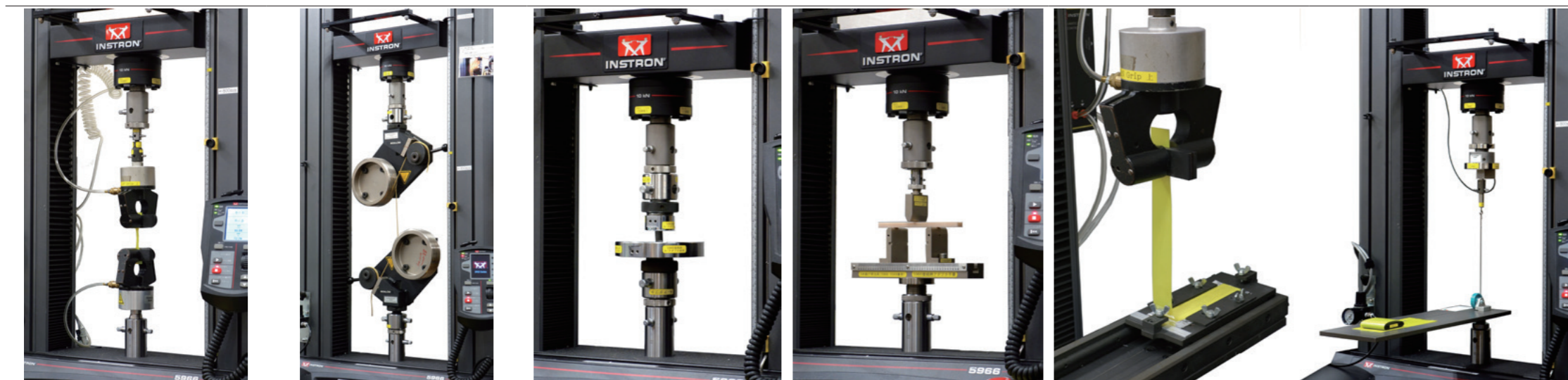
図2 ケーブルチャック(直径150mm)での引張試験
