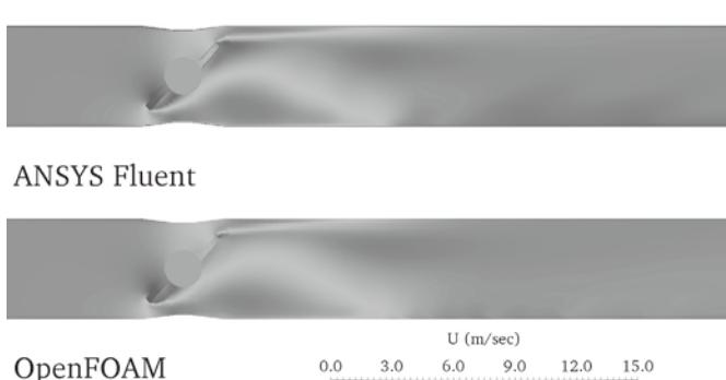
図 5 流速分布(45deg  $\Delta p=60$ kPa)
