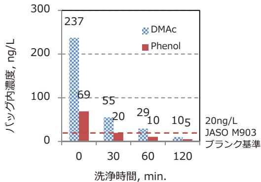
図 5 ガス流量 1.0mL/min における、洗浄時間とバッグ内の残存 VOC 濃度の関係
