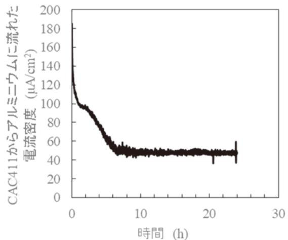
図 20 CAC411 とアルミニウム間に流れたガルバニック電流の時間変化
