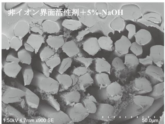
図 10 精練方法を変更した A-3 法試料の繊維断面
