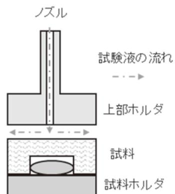
図 1 従来の隙間噴流試験機の試験部の模式図
