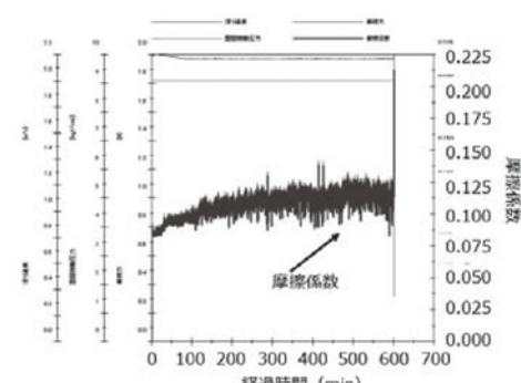
図 13 摩擦摩耗試験（ $10\text{h}$ 、乾燥中）挙動
