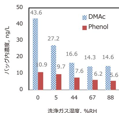
図 3 洗浄ガスの湿度とバッグ内に残存する VOC 濃度の関係
