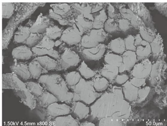
図 6 水洗せずに乾燥させた A-3 法試料
