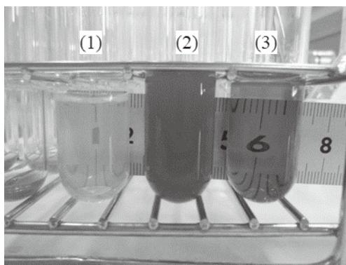
図 17  $\text{CrO}_3$  による  $\text{S}^{2-}$  の  $\text{SO}_4^{2-}$  への酸化の確認実験
