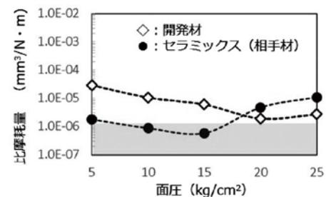
図5 未加工材摺動における比摩耗量におよぼす面圧の影響
