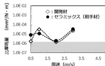
図6 未加工材摺動における比摩耗量におよぼす周速の影響
