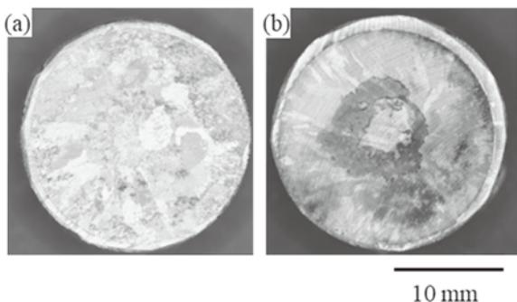
図11 流量 1.4L/min で隙間噴流試験を行った後の CAC411 および CAC406 の外観写真
