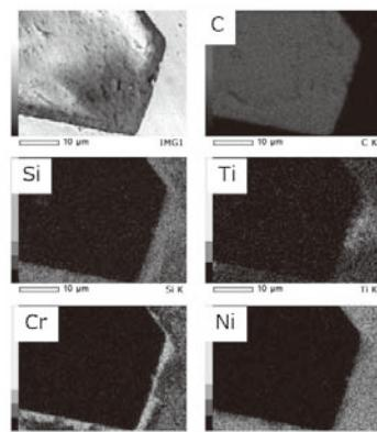
図 3 硬質粒子（ダイヤモンド粒子）と接合層界面の EDS 分析
