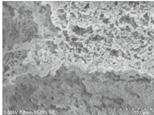
図 2 フッ素樹脂微粒子層化表面の電子顕微鏡像
