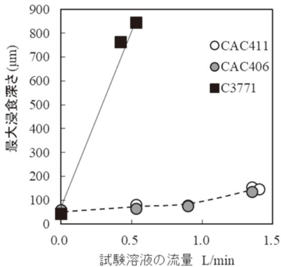
図10 隙間噴流試験における流量と最大浸食深さの関係
