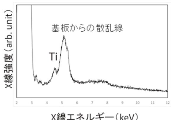
図 4 電気化学的手法により形成された TiO<sub>2</sub> 被膜の EDX スペクトル 条件②で形成された被膜に Ti が含まれていることを示す
