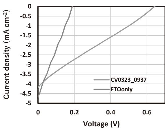
図6 ソーラーシミュレーターによるJV特性 勾配の小さいデータが開発品、急勾配のデータが基板のみの特性を示す
