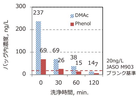
図 4 ガス流量 0.5mL/min における、洗浄時間とバッグ内の残存 VOC 濃度の関係
