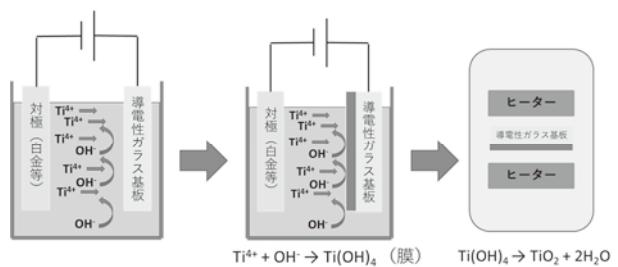
図 3 電気化学的手法による酸化チタン法の概略
