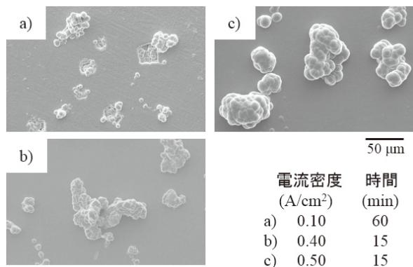
図13 CAC411 上のクロムめっきの電流密度による表面形状の変化
