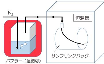
図 1 加湿法によるバッグの洗浄モデル
