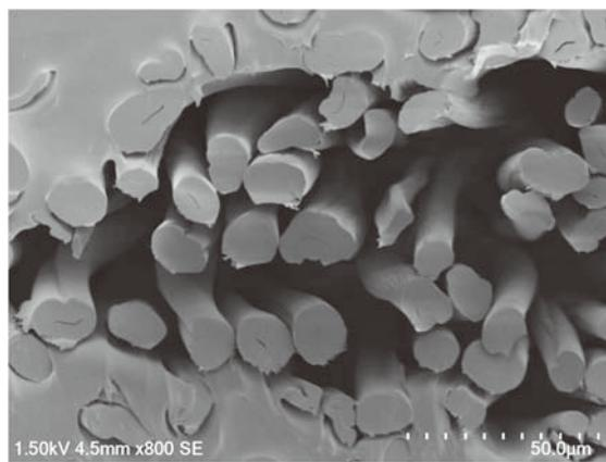
図3 無緊張マーセル化試料の纖維断面
