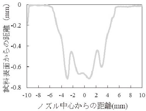
図 5 隙間噴流試験後の C3771 の表面形状
