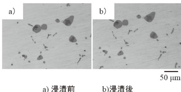
図 15 CAC411 をクロムめっき液に浸漬することによる硫化物の変化
