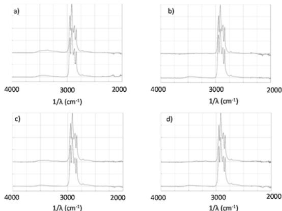
図1 ポリプロピレン、ポリビニルアセタールのブレンド(75:25)樹脂成形体の表面と断面の赤外分光スペクトル ポリビニルアセタールの組成は、a) A、b) B、c) C、d) D 各図の上は表面、下は断面のスペクトルである。
