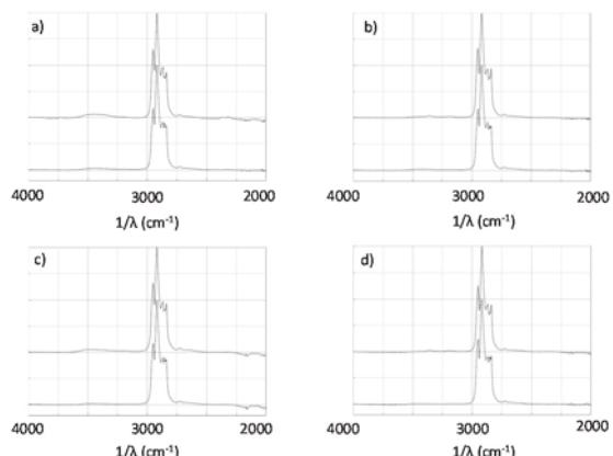
図2 ポリプロピレン、EPDM、ポリビニルアセタールのブレンド(50:25:25)樹脂成形体の表面と断面の赤外分光スペクトル ポリビニルアセタールの組成は、a) A、b) B、c) C、d) D 各図の上は表面、下は断面のスペクトルである。
