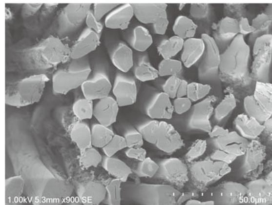
図 9 湯で水洗した A-3 法試料の纖維断面
