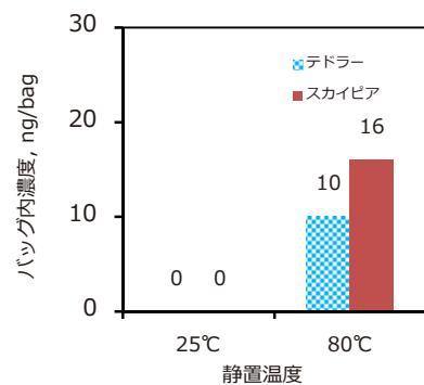
図8 一定温度静置後にテドラー<sup>®</sup>バッグおよびスカイピア<sup>®</sup>バッグ内部に含まれるホルムアルデヒド濃度
