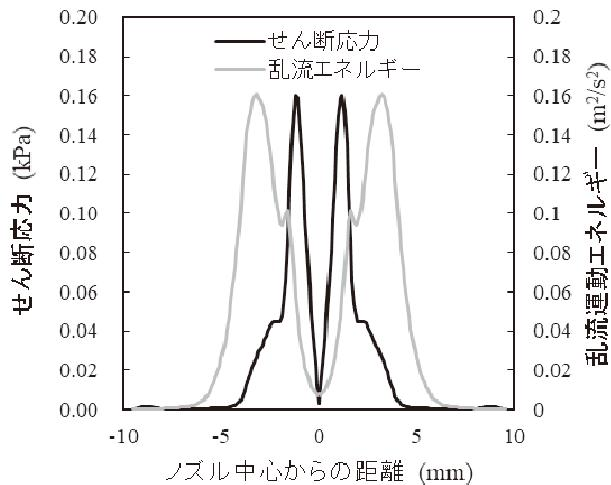
図 6 試料直上におけるせん断応力および乱流運動エネルギーの分布
