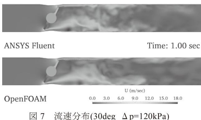
図 7 流速分布(30deg  $\Delta p=120\text{kPa}$ )
