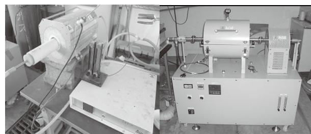
図 4 管状炉、およびロータリーキルン
