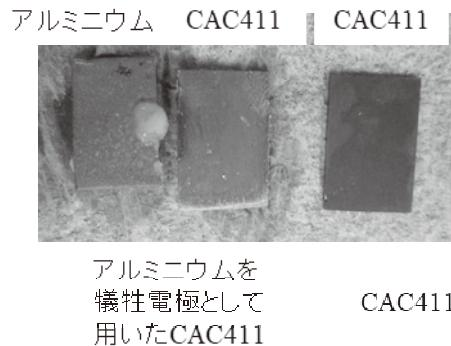
図 21 アルミニウムを犠牲電極として海水中に 28 日浸漬した CAC411 の表面
