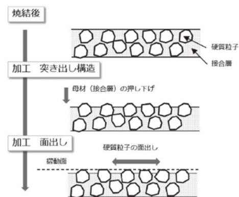
図7 後加工の手順模式図
