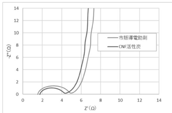
図 11 Cole-Cole-plot による市販導電助剤と CNF 活性炭導電助剤の比較
