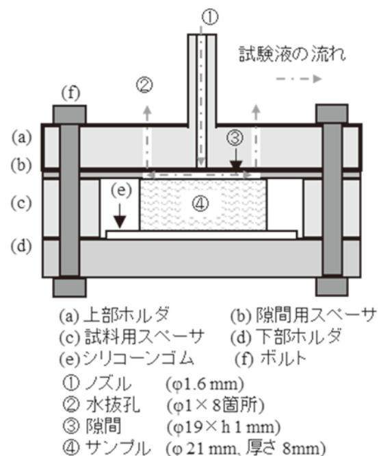
図 2 開発した隙間噴流試験機の試験部の模式図
