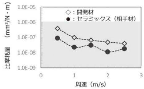
図 11 後加工材摺動における比摩耗量におよぼす周速の影響
