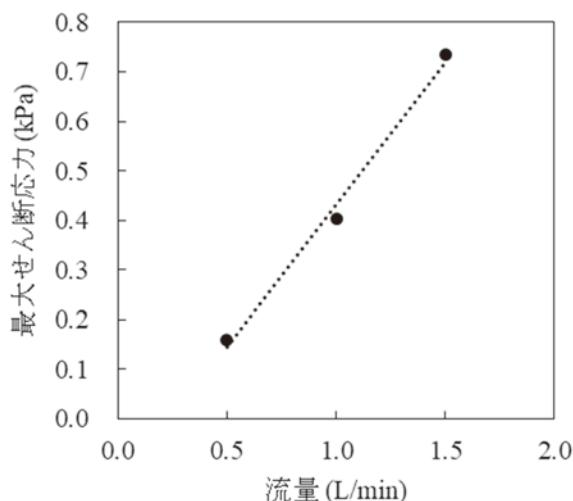
図 7 隙間噴流試験における流量と試料に加わる最大せん断応力の関係
