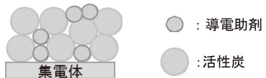
図 2 EDLC 電極の構造
