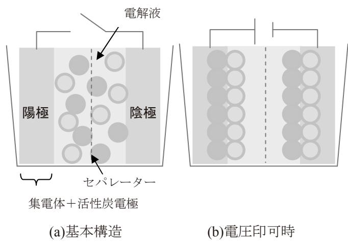
図 1 EDLC の基本構造と蓄電原理
