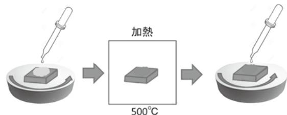
図 2 ペロブスカイト型太陽電池電子輸送層の従来形成法 FTO ガラス基板に 500°C以上の温度で形成する
