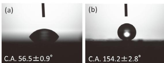
図 1 接触角の評価結果
