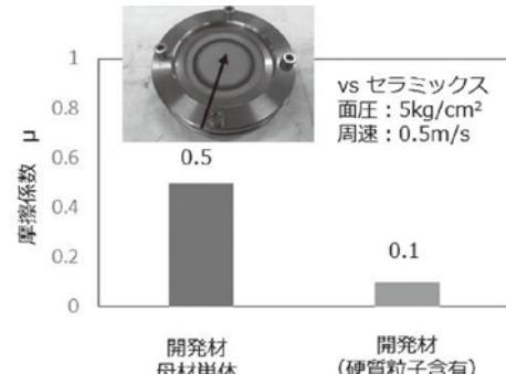
図 12 摩擦係数におよぼす硬質粒子（ダイヤモンド粒子）の影響
