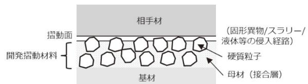
図 1 開発材料の設計概念図
