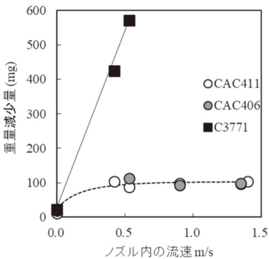
図9 隙間噴流試験における流量と重量減少量の関係
