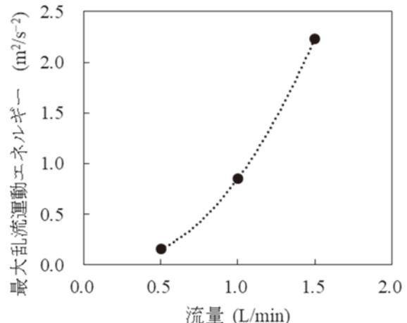
図 8 隙間噴流試験における流量と試料に加わる最大乱流運動エネルギーの関係
