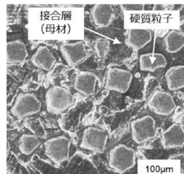
図8 後加工（突き出しおよび面出し加工）後のサンプル表面写真
