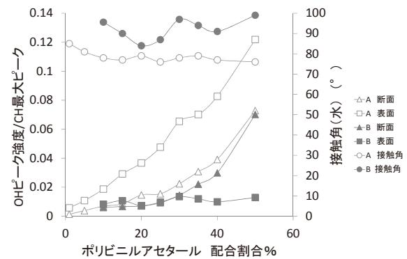
図 3 ポリビニルアセタールの配合割合と赤外分光スペクトルにおける CH 伸縮振動の最大ピーク強度に対する OH ピーク強度の割合、およびサンプル表面の水に対する接触角
