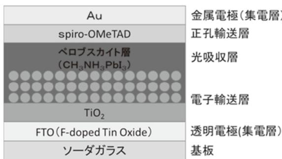
図 1 ペロブスカイト型太陽電池の概略図
