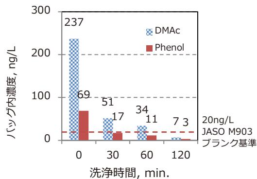
図 6 ガス流量 2.0mL/min における、洗浄時間とバッグ内の残存 VOC 濃度の関係
