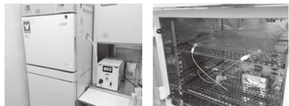
図 2 洗浄試験に用いた全自动加湿洗浄装置と恒温槽（左）および洗浄中の様子（右）
