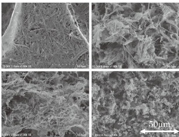
図 7 凍結乾燥調製後の CNF、および CNF 炭化物の SEM 写真
