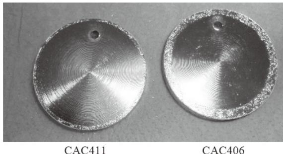
図 19 CAC411 および CAC406 にニッケルめっきを下地めっきしたクロムめっきの中性塩水噴霧試験 196 時間後の外観写真
