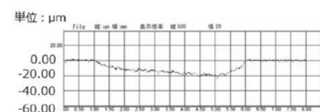
図 14 摩擦摩耗試験（ $10\text{h}$ 、乾燥中）後の断面プロファイル
