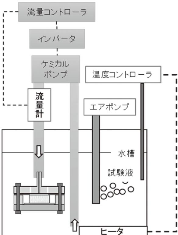
図3 開発した隙間噴流試験機の模式図
