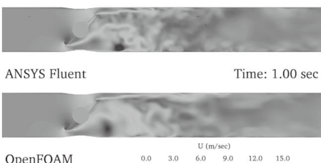
図 8 流速分布(45deg  $\Delta p=60\text{kPa}$ )
