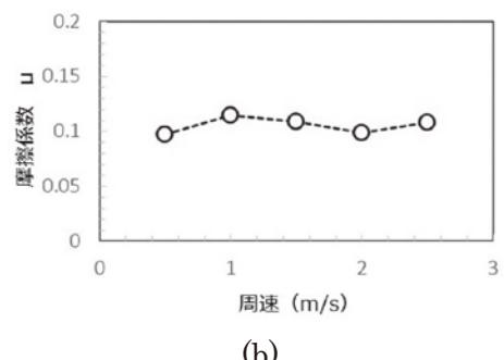
図9 後加工材摺動における摩擦係数におよぼす(a)面圧および(b)周速の影響
