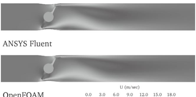
図 4 流速分布(30deg  $\Delta p=120$ kPa)
