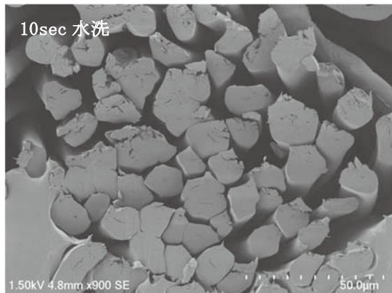
図 12 水酸化ナトリウム水溶液に浸漬後、水洗してからねじり処理を行った A-3 法試料の繊維断面
