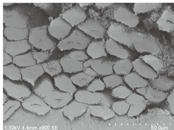
図 11 水酸化ナトリウム水溶液に浸漬後、脱水してからねじり処理を行った A-3 法試料の繊維断面
