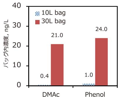
図7 各容量における洗浄後のバッグ内残存VOC濃度
