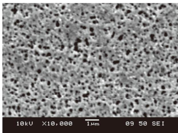
図 5 電気化学的手法により形成された TiO<sub>2</sub> 被膜の SEM 像 基板上に均一に被膜が形成されているとともにポーラスな被膜になっていることがわかる。
