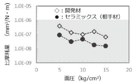
図 10 後加工材摺動における比摩耗量におよぼす面圧の影響
