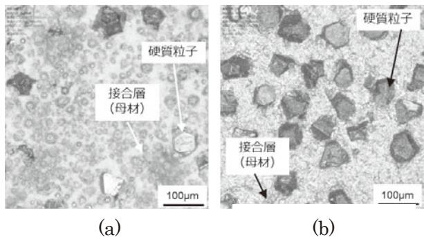
図 2 焼結体表面観察写真 (a)焼結直後、(b)接合層を押し下げる突き出し加工後
