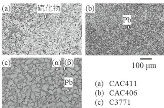
図 4 隙間噴流試験に用いた銅合金試料の金属組織写真
