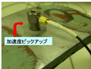
写真 3 振動センサの取り付け状態
