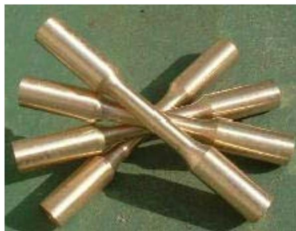
写真2. 鉛フリー銅合金4号試験片
