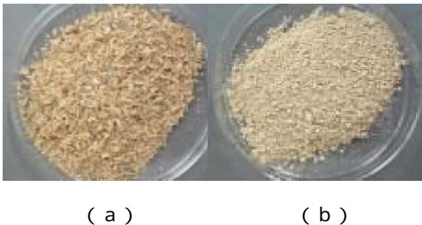
図1. 機械粉碎後の籾殻: (a)未処理, (b)酵素処理
