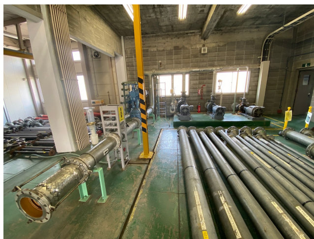
図 1 バルブ性能試験装置
