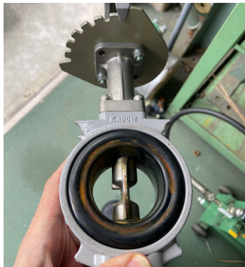
図3 供試弁 (50A バタフライ弁)
