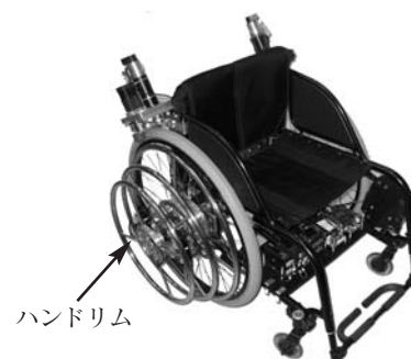
図2 片手用車椅子の外観
