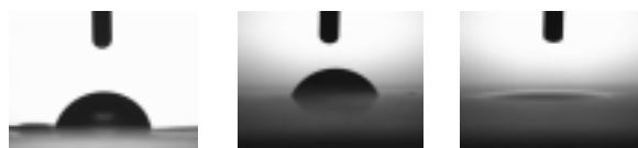
Fig.8 接触角測定結果；左からそれぞれ PVA：シリカ = 10:0、7:3、5:5
