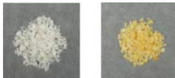
Fig. 12 乾式法によるサンプル 左：EVOH のみから得たサンプル 右：PVA/PAAm ブレンドで得たサンプル
