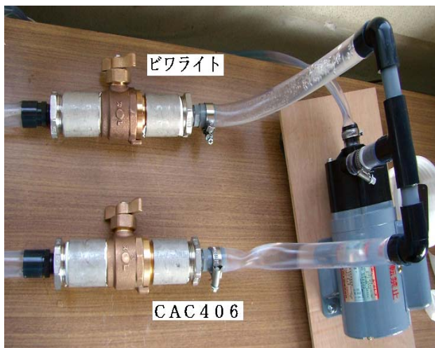
写真3. ビワライト製玉型弁の通水試験
