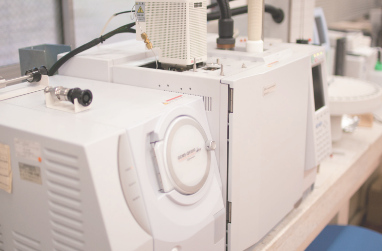
ガスクロマトグラフ質量分析装置
