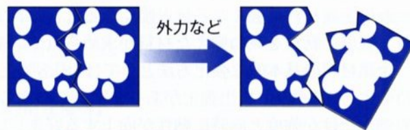
図2 界面接着力が弱い例(脆い材料例)
