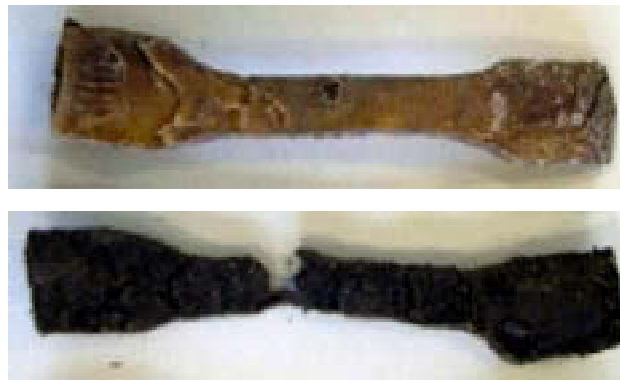
写真２．セリシンブレンドによる生分解性（埋没期間：１年２ヶ月）：(上)セリシン含率 0wt%、(下)セリシン含率 10wt%。
