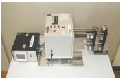
写真3 フィルム自動延伸装置(赤外二色比測定用)
