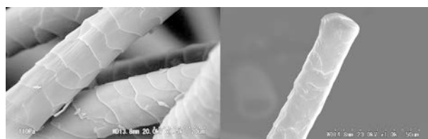
図6 左:通常の羊毛と 右:クリーニングによってダメージを受けた羊毛
