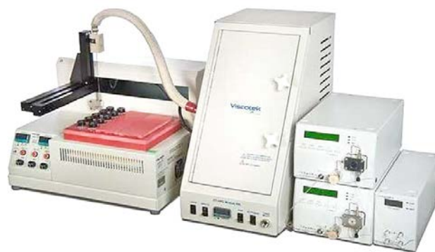
図1 高温GPCシステムの外観
