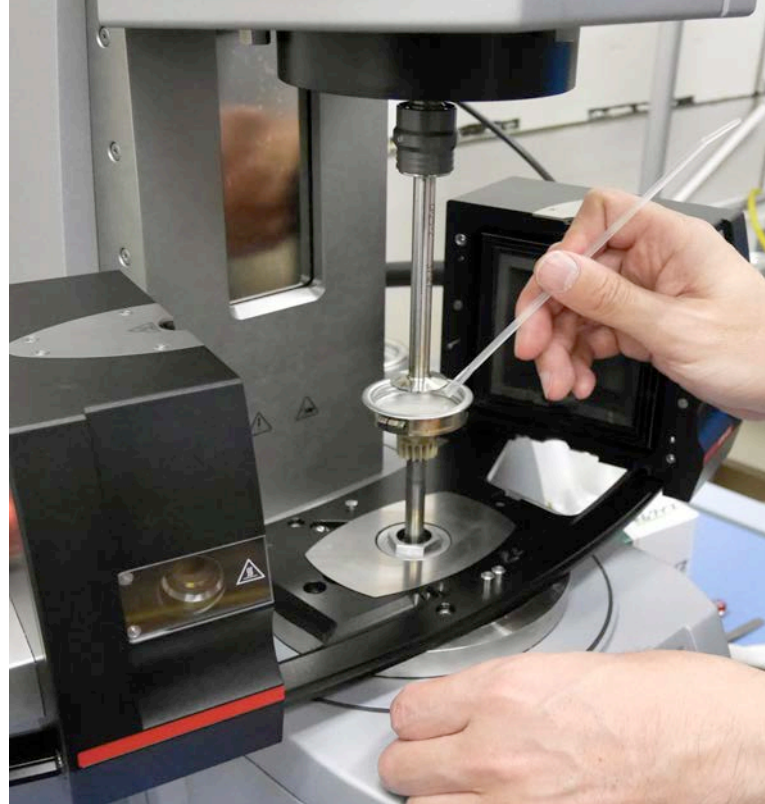
プラスチック粘弾性測定装置(H26年度)
