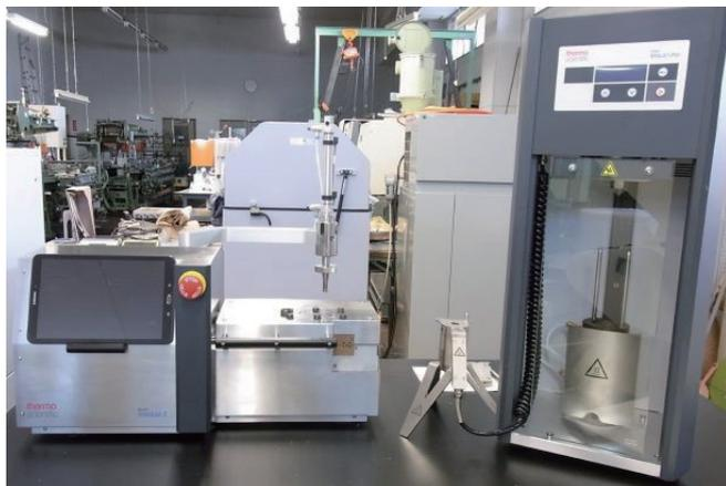
図1 小型押出成形機
