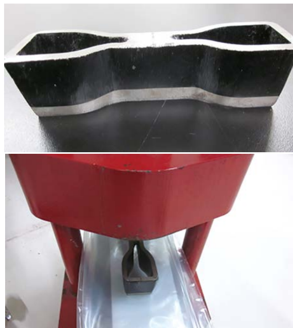
図9 打ち抜き型と油圧プレスを用いた打ち抜き
