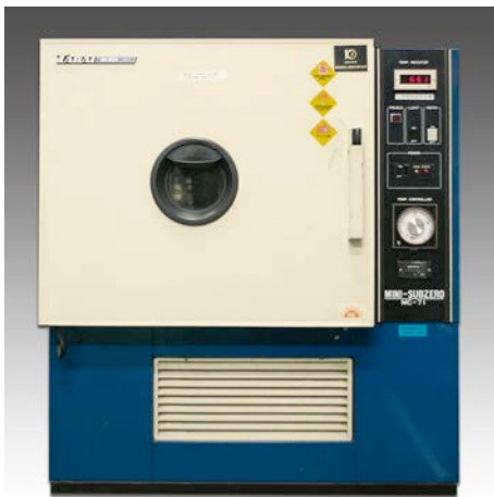
小型超低温恒温槽(彦根庁舎)
