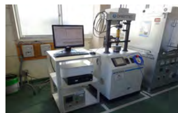
図2 回転式摩擦摩耗試験機 (株)エー・アンド・デイ製 EFM-3-H
