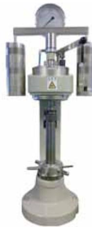
超硬合金球（φ5mm、φ10mm）を圧子に用いて荷重を負荷し、専用の顕微鏡を用いて圧痕の直径を測り、大きさから硬さを求めます。
