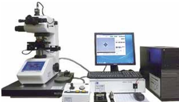
ビッカース硬さとヌープ硬さは同一の試験機を用いて、それぞれの圧子を変更して測定を行います。ヌープ圧子は薄膜など薄い材料に使用します。
