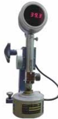
鋼球を一定の高さから試験片に落下させ、その跳ね返りの高さから硬さを求めます。目測で読み取るC型、ダイヤルゲージで読み取るD型がありますが、当センターで利用できるのはデジタル形式での読み取りが可能なD型になります。このタイプは、自動的に指
