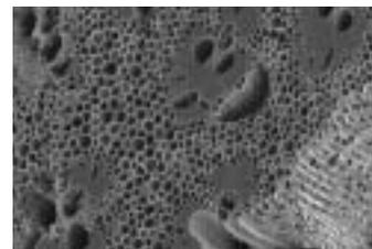
図 竹活性炭のSEM写真 (断面)
