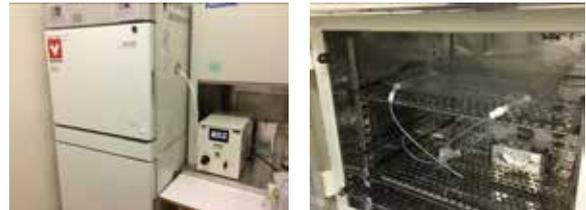
図 2 洗浄試験に用いた全自動加湿洗浄装置と恒温槽 (左) および洗浄中の恒温槽内の様子 (右)
