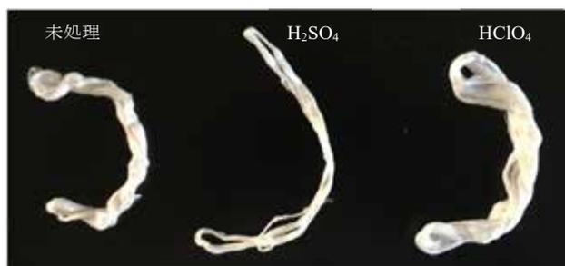
図 3 硫酸および過塩素酸を触媒としてアセチル化した綿試料
