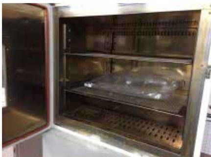
図3 放散試験中の恒温槽内の様子
