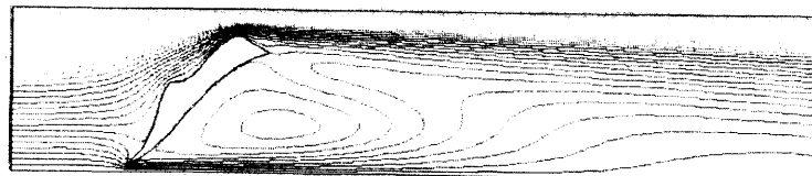
図26 ノズル側軸上流型弁体の流線 (境界条件4)
