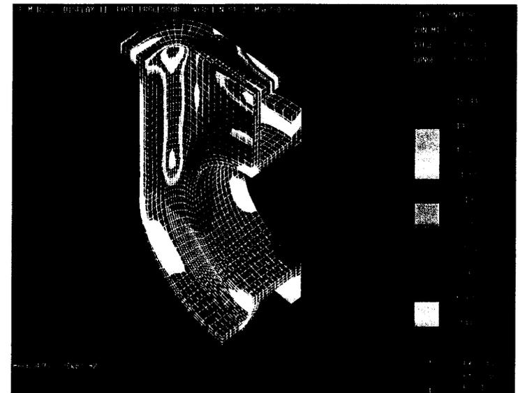
图17-2 3次元応力図 (von-mises 応力)
